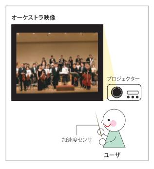
プロジェクターでオーケストラの映像を映す。ユーザが 持つ指揮棒には加速度センサが組み込まれていて、ユー ザの指揮棒を振る早さで演奏の早さが変わる。
